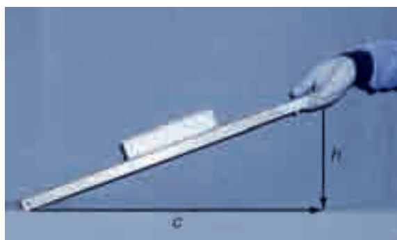
Hình 25.3 Nghiêng tấm ván để đo ma sát
